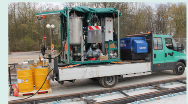
Spezialmischanlage – bis 25 Liter pro Minute
