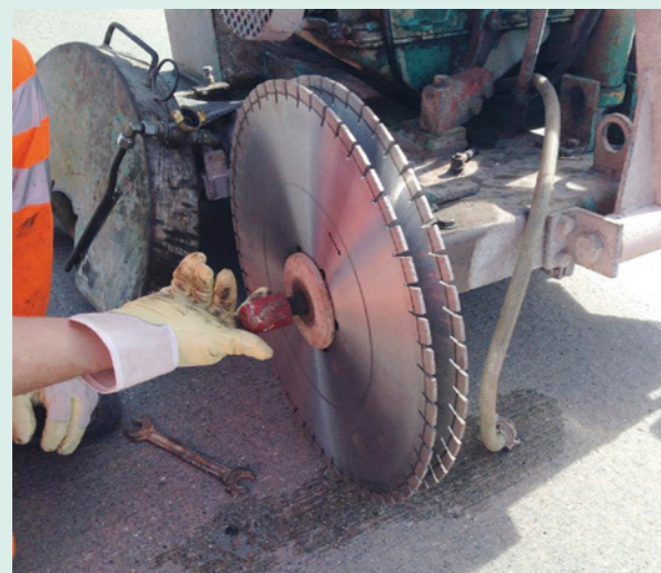
Diamantscheiben für Parallelschnitt
